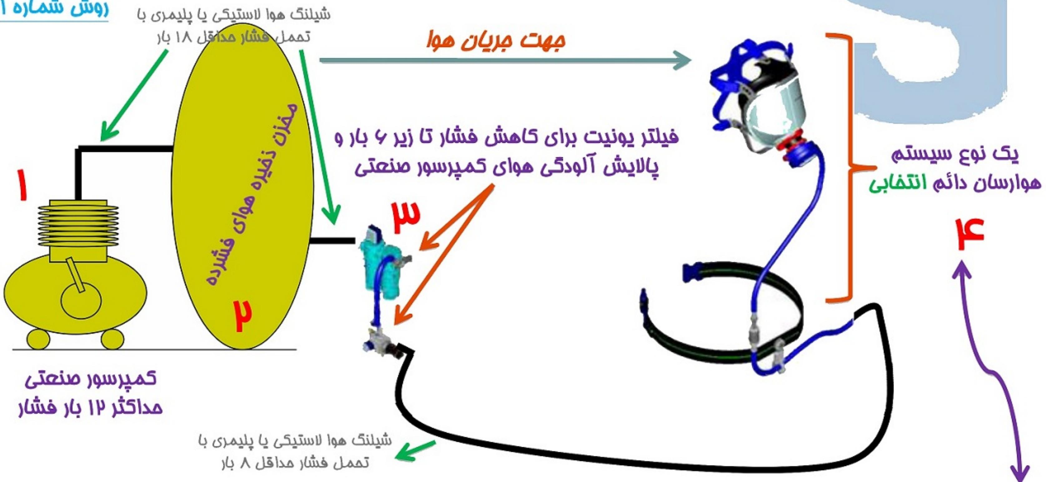
\***توجه:** این سیستم انتخابی می تواند بنا بر نیاز یکی از سیستم های هوارسان دائم ۱۹۰ ، AC 952 و ACS 952 یا مطابق تصویر فوق، ماسک تمام صورت فشار مثبت ( $\mu$  میلی بار فشار داخلی) به همراه دیماندولو، شیلنگ (ابط، کوبیلنگ مربوطه و کمربند باشد .
