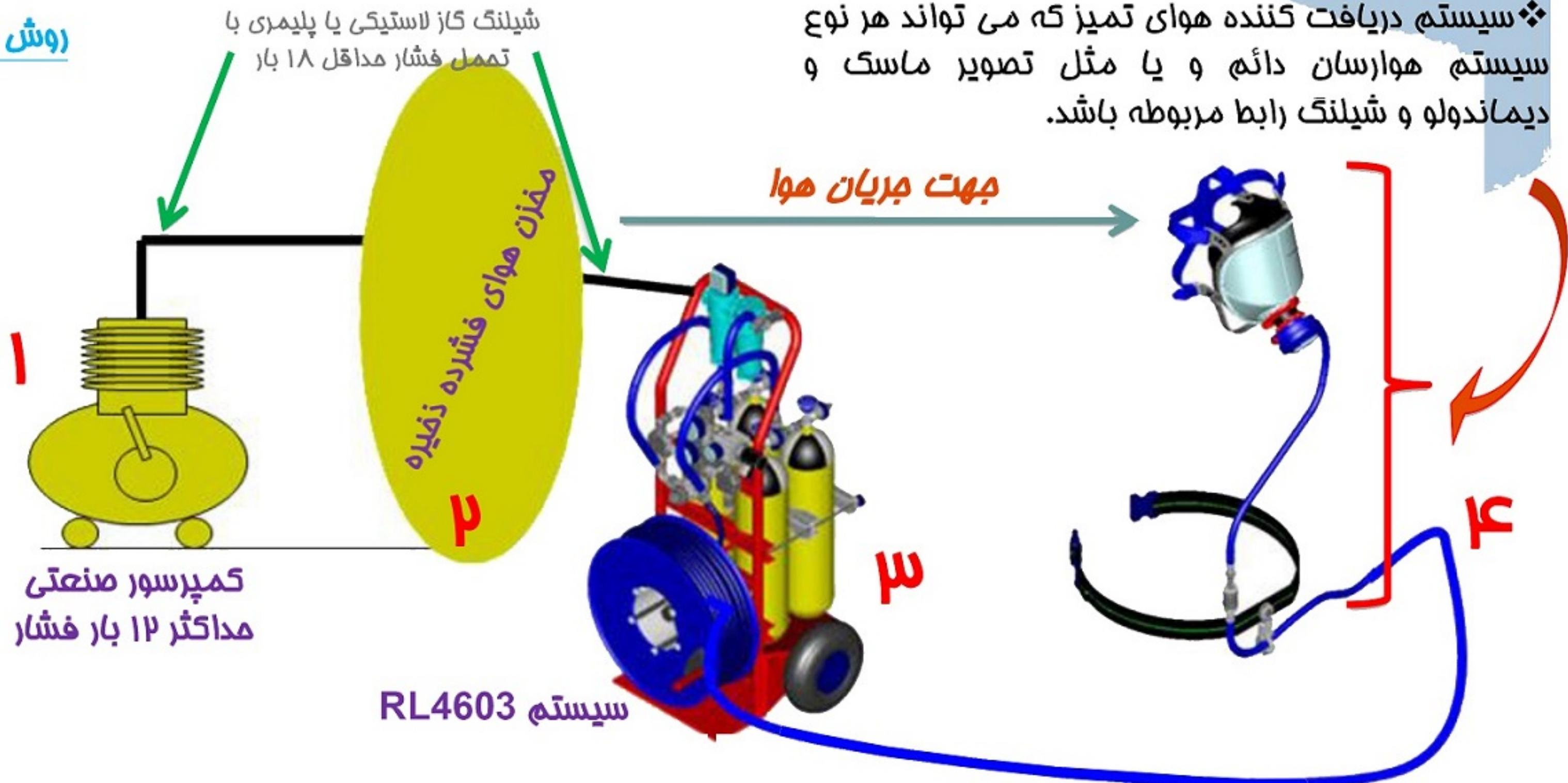
❖ سیستم RL4603 بعنوان واسطه در یک مجموعه هوارسان دائم، در مواقع بروز مشکل نظیر خرابی کمپرسور، ۱۴ ساعت ذخیره هوا را برای اپراتور تأمین می نماید. ( Air filter Unit ) مستقر روی این سیستم عمل تعدیل فشار و پالایش هوا را نیز انجام می دهد.
